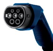
Connettore e prese per sistemi in corrente alternata monofase e trifase, che rappresenta la soluzione proposta come standard per l'UE. Viene utilizzato principalmente dai produttori europei ed è la base di connessione più adatta ai punti di ricarica, in quanto supporta anche il tipo 1 sul connettore lato VE. Dotato di 7 terminali (3 fasi, neutro, terra e 2 comunicazione). Supporta la ricarica sia lenta che veloce.
