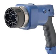
Connettore progettato specificamente per la ricarica rapida in corrente continua, è lo standard dei produttori giapponesi. Ha dieci terminali, messa a terra e comunicazione con la rete. Ammette fino a 200 A di corrente (per ricariche ultraveloci). È quello con il diametro maggiore, sia nel connettore che nel cavo. La presa si trova solo sul lato veicolo.
