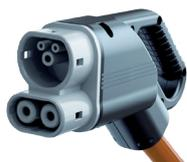
È la soluzione europea per le ricariche in corrente continua. Utilizza i terminali di comunicazione e di terra del connettore di tipo 2 con l'aggiunta di due terminali per la corrente continua. I veicoli dotati di questa presa consentono la ricarica in corrente alternata con il connettore Tipo 2 e la ricarica rapida in corrente continua con il connettore mobile COMBO 2. La presa si trova solo sul lato veicolo.
